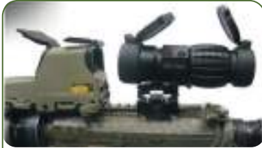
Іл. 20.16. Поєднання коліматора (ліворуч) та магніфікатора (праворуч) на одній Пікатіні
