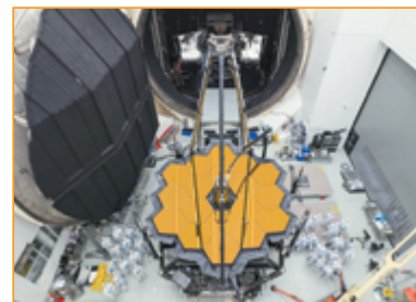
Рис. 3.2 Сегментоване дзеркало новітнього космічного телескопа «Джеймс Вебб»
