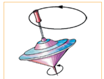
Рис. 1.4. Явище прецесії демонструє дитяча дзига, що обертається навколо власної осі, у той час як її вісь описує конус у просторі
