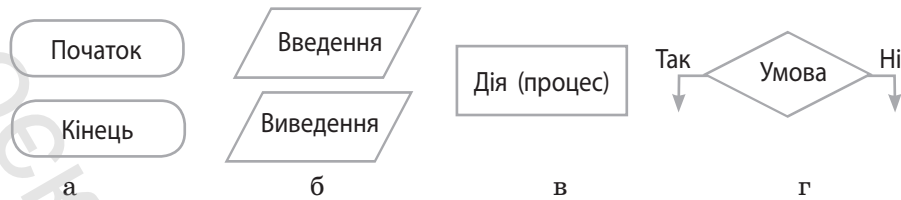
Рис. 5.2. Основні графічні позначення на блок-схемах: термінатори (а); дані (б); дія (процес) (в); перевірка умови (г)
