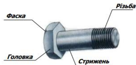
Рисунок 40 Конструктивні елементи болта
