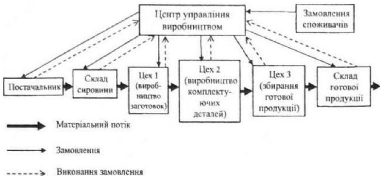
Рис.1.15- Схема функціонування штовхаючої системи
