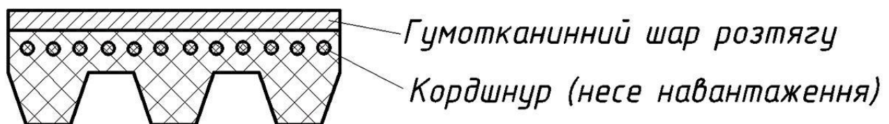
Рисунок 14.7 – Переріз поліклинового паса
